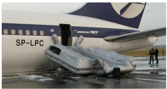
Figure 8. Escape slide at door 3L.
