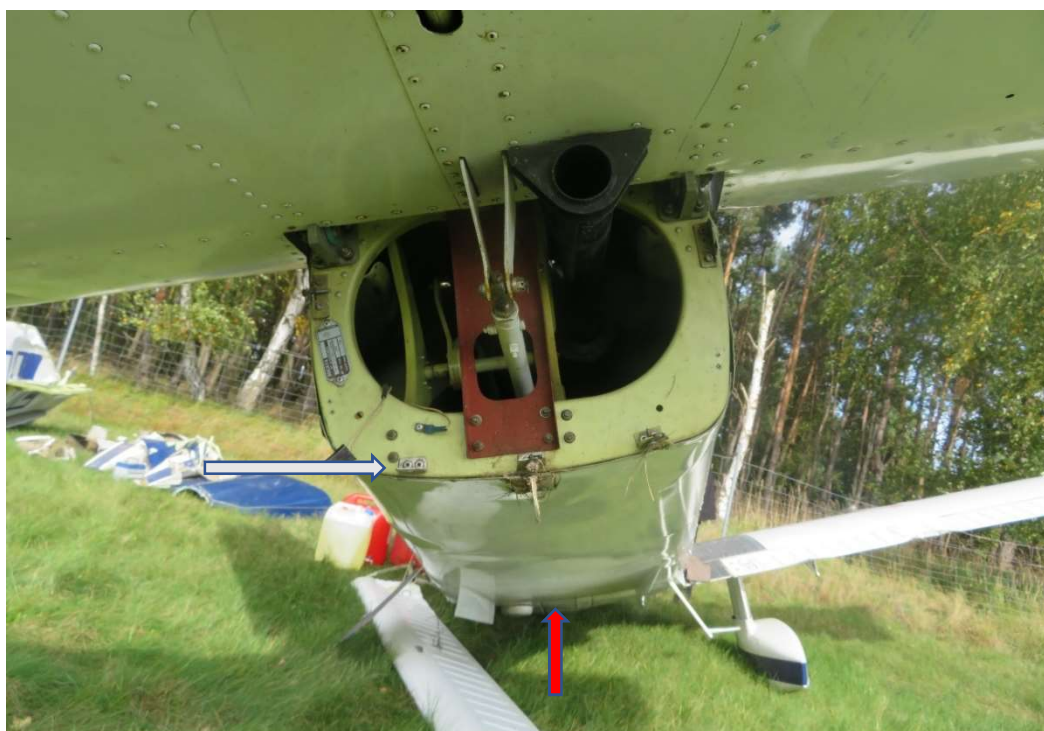
Rys.5 Uszkodzenia tylnej części kadłuba (brak osłony oraz wgniecenia na dolnej części kadłuba) [źródło: PKBWL]
