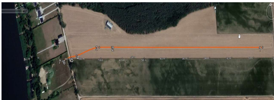
Rys. 8 Trasa startu samolotu: 1-początek rozbiegu, 2-oderwanie i lot na krytycznych kątach natarcia (650 m), 3-zakręt w lewo, 4-uderzenie ogonem o ziemię, 5-zderzenie z ogrodzeniem, 6-miejsce oderwania lewego skrzydła, 7-miejsce zatrzymania samolotu [źródło: PKBWL]
