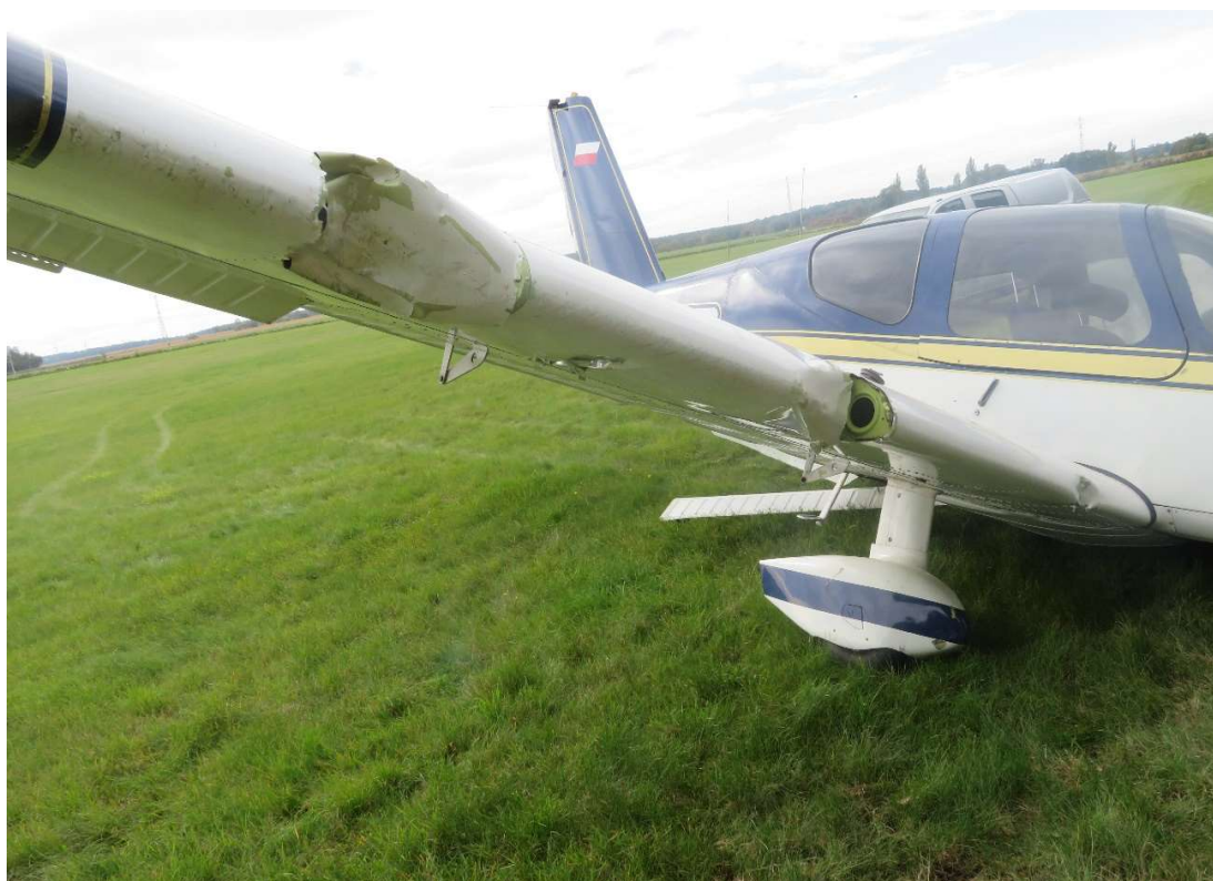
Rys.3 Uszkodzenia krawędzi natarcia prawego skrzydła
